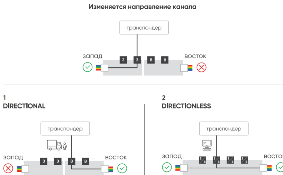
Рисунок 6-97. Переключение направления канала в линиях – Directional: требуется физическое переключение портов 2 – Directionless: канал можно подключать к любому порту и на любое выбранное направление (но только на одно)
