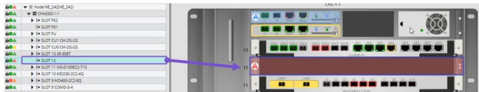
Рисунок 5-14. Provisioning платы выполнен, но плата отсутствует в слоте шасси или выключено питание – administrative-state: locked .
